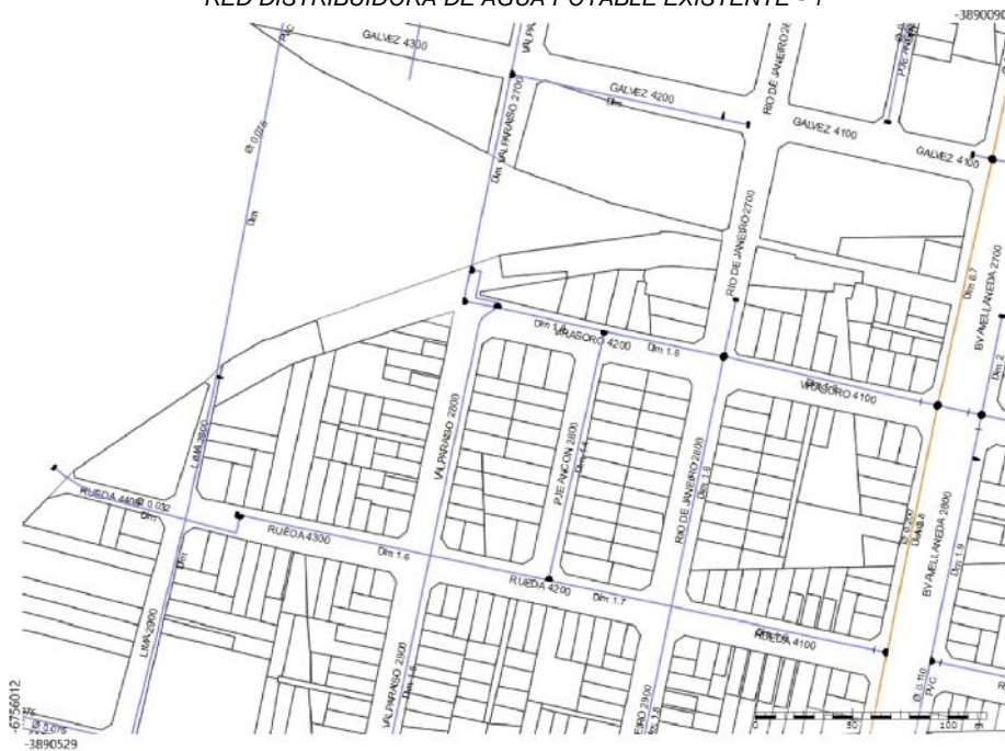
RED DISTRIBUIDORA DE AGUA POTABLE EXISTENTE - 2
