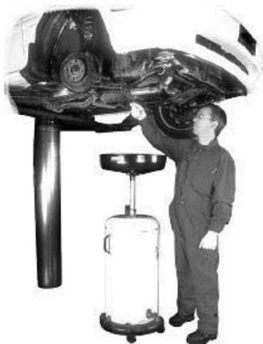
Recepción y almacenamiento de aceite lubricante usado y drenaje de filtros
