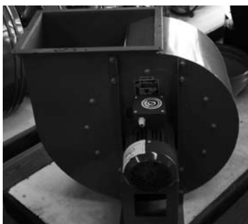
Extractor centrífugo con fácil acceso para su limpieza
