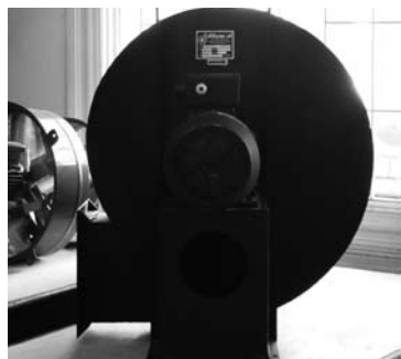
Extractor centrífugo sin fácil acceso para su limpieza
