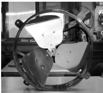
Extractor axial de bajo caudal y presión
