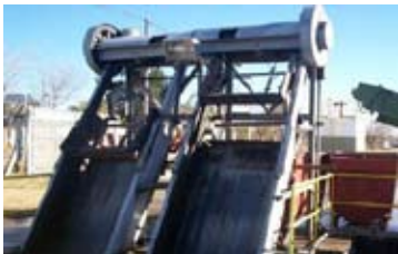
Reja de limpieza automática
